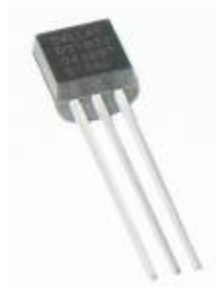
รูปที่ 4.2 โครงสร้างของตัวตรวจวัดอุณหภูมิเบอร์ DS18B20
